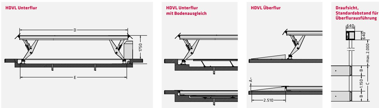
Optional: Auffahrrampen in der Länge 2.510 mm für ein Überfahren der Überflurhebebühne. In der Länge 3.300 mm für ein einfacheres Befahren der Fahrschienen auch mit Niederflurfahrzeugen.
