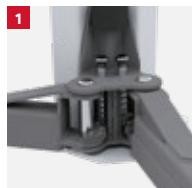
1 Il sistema di arresto bracci automatico garantisce all'operatore la massima sicurezza e stabilità.
