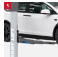
3 Perfetto per veicoli elettrici. La flessibilità di rotazione dei bracci permette di avere un accesso diretto al pacco batteria in operazioni di rimozione della stessa.
