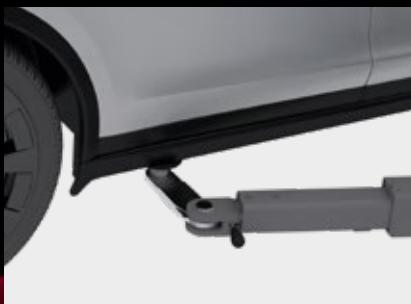
Le tampon de préhension est facile à régler en fonction du type de véhicule soulevé.
