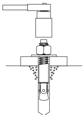
Ziehen Sie die Mutter mit einem Drehmomentschlüssel fest. Zur Verwendung von chemischen Verbundankern lesen Sie bitte das Handbuch des Herstellers der Verankerungen.
