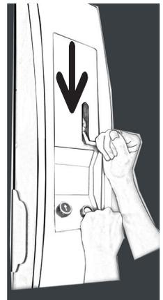
**i** Der Sicherheitsentriegelungsgriff besitzt eine Totmann-Schaltung. Muss zum Absenken der Hebebühne heruntergedrückt werden. Setzen Sie diese selbstschließenden Hebebühnensteuerelemente nicht außer Kraft.
