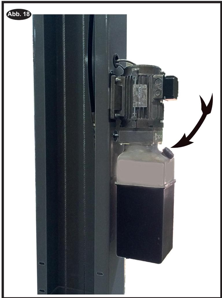
3. Setzen Sie den Hydrauliköltank ordnungsgemäß wieder ein.
