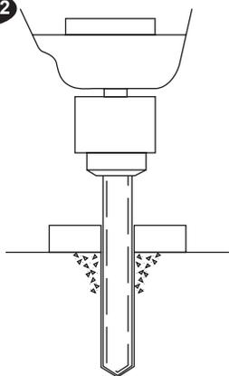
Verwenden Sie für das Bohren der Löcher die korrekte, mit Hartmetall bestückte, Steinbohrspitze.
