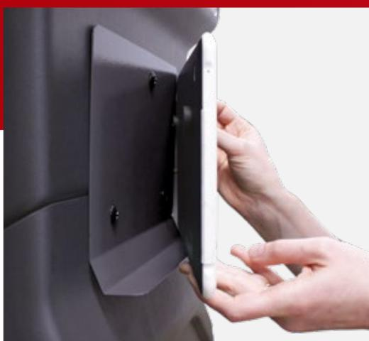
Tablet con display multi-touch 800 x 1280 a 10" dotato di magneti adesivi. Ricaricabile sul pannello.
