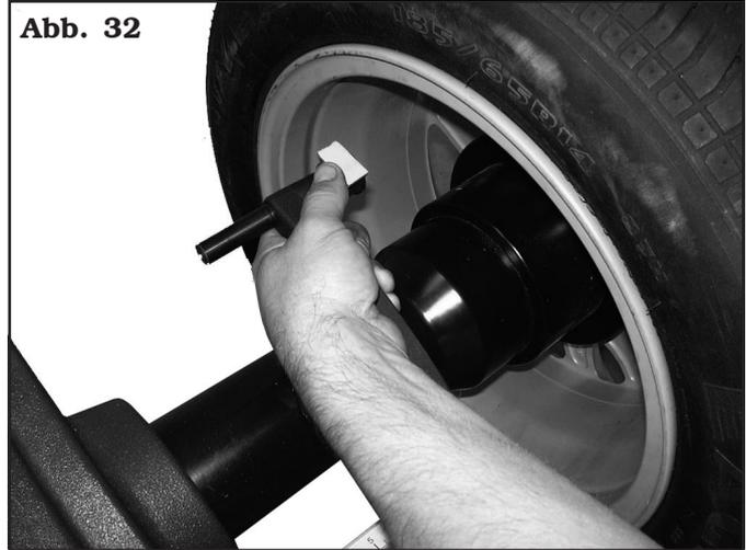
Lesen Sie das Abstandsmaß auf dem manuellen Abstandstaster ab. Bringen Sie das Klebegewicht auf der Radaußenseite an (**Abb. 33**). Halten Sie sich an den angegebenen Abstand (175 mm im Beispiel) und verwenden Sie ein Gewicht, das dem erfassten Wert entspricht (das Beispiel zeigt 30 g). Die Position des Außengewichtes ist nicht ersichtlich, aber intern verborgen.
