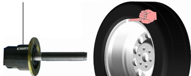
Den markierten Reifenanhaltspunkt dem Pfeil am Flansch gegenüber positionieren
