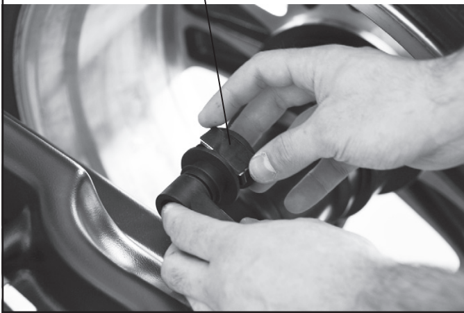
Fig. 45 Introducir en la pinza del eje del palpador el peso adhesivo
