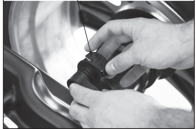
Fig. 38 Introducir en la pinza del eje del palpador el peso adhesivo
