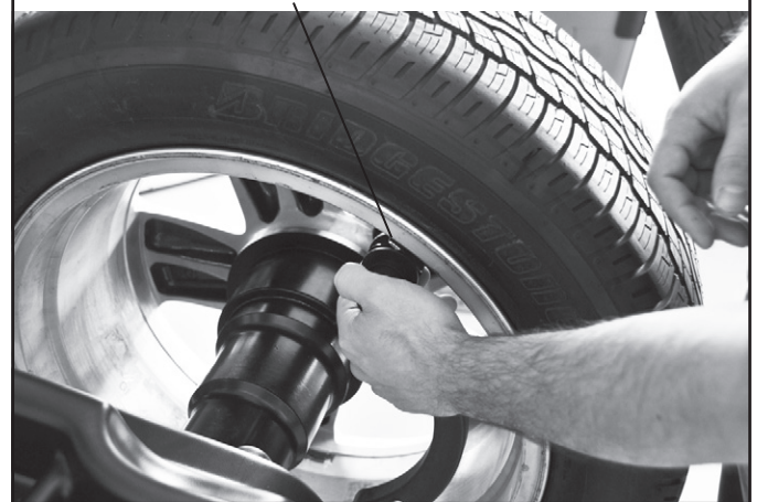
Aplicar el peso en la posición en la cual la pinza del peso toca la rueda
