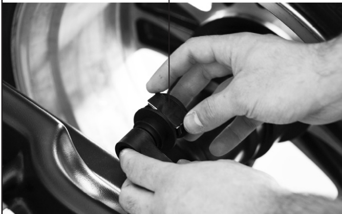
Fig. 32 Introducir en la pinza del eje del palpador el peso adhesivo
