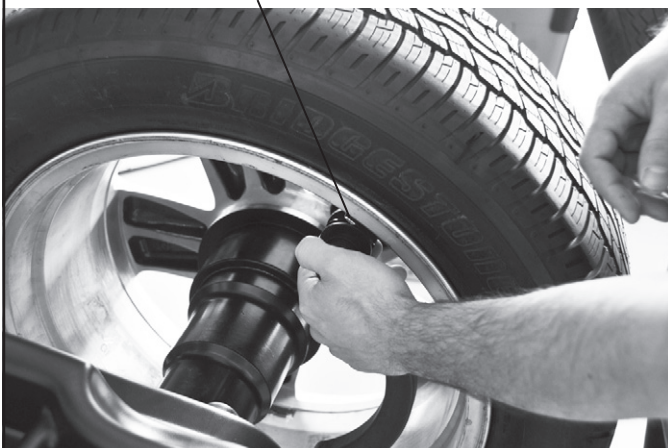
Fig. 46 Aplicar el peso en la posición en la cual la pinza del peso toca la rueda
