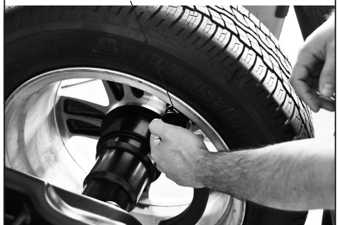
Fig. 34 Aplicar el peso en la posición en la cual la pinza del peso toca la rueda
