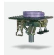
**GA per autovettura:** Universale per autovetture. Ideale per cambi automatici. Cinghia di pensionamento per fissare il carico, ampia superficie di appoggio in gomma, capacità del sollevatore 400 kg, Ø perno 35 mm, dimensioni 300 x 240 mm (utilizzabile solo in combinazione con l'attacco universale, art. n. 103544). (Art. n. 3136)
