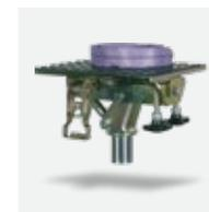
**GA Pkw** : utilisation universelle pour les voitures particulières. Convient parfaitement aux boîtes de vitesses automatiques. Sangle de serrage pour sécuriser la charge, grande surface d'appui en caoutchouc, capacité de charge 400 kg, tourillon Ø 35 mm, dimensions 300 x 240 mm (utilisable uniquement en combinaison avec la fixation universelle, réf. 103544). (Réf. 3136)
