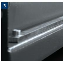
**1** I cilindri principali sono dotati di un dispositivo di arresto pneumatico sbloccabile. La striscia a cricchetto è avvitata e regolabile tramite viti.
