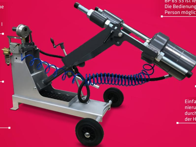
Die Achsschenkelbolzenpresse BP 65 S3 ist leicht zu rangieren. Die Bedienung ist durch nur eine Person möglich
