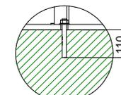
Die Mindestverankerungstiefe des Dübels beachten. Mit Estrich/Fliesen sind längere Dübel einzusetzen. Observe the min. anchorage of the dowels. With floor pavements, tiles use longer dowels.
