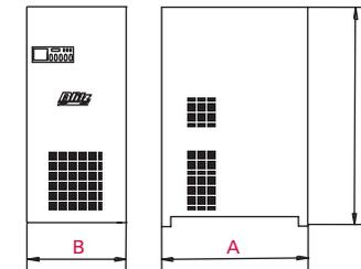
\* Portata m<sup>3</sup>/h a +20°C e 1 bar ed una temperatura di ingresso aria esattamente di +35°C, pressione di esercizio della serie BT R 7 bar, punto di rugiada in pressione +3°C. Perdita di pressione: In condizioni normali, nell'essiccatore <0,2 bar, nel filtro <0,15 bar, perdita di pressione totale: <0,35 bar
