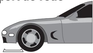
Ecart moyen inférieur à 2,7 m (105") : positionner la roue avant gauche sur le côté d'approche du plateau de support de roue.
