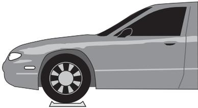
Ecart moyen de 2,7-3,2m (106"-127") : positionner la roue avant gauche dans le plateau de support de roue.
