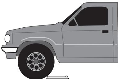
Ecart moyen supérieur à 3,2m (127") : positionner la roue avant gauche immédiatement devant le plateau de support de roue.
