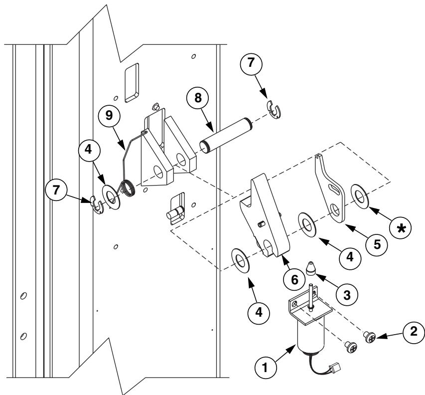
**ПОДРОБНЫЙ ПЕРЕЧЕНЬ СБОРОЧНЫХ ЧАСТЕЙ ФИКСИРУЮЩЕЙ ЗАЩЕЛКИ**
