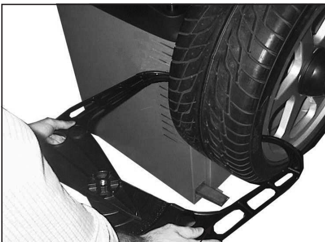
PIGE EXTERNE ROUES Relevé manuel largeur de la jante
