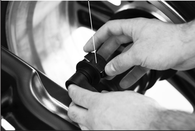
Fig. 47 Introduire le poids adhésif dans la pince de la tige de la pige
