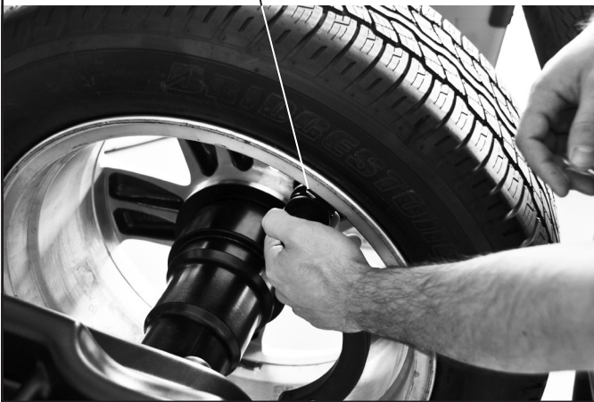
Appliquer le poids dans la position où la pince touche la roue Fig. 48
