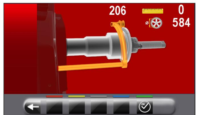
Posicionar el palpador (Fig. 45 ref. 1) sobre la brida del mandril (Fig. 45 ref. 2).
