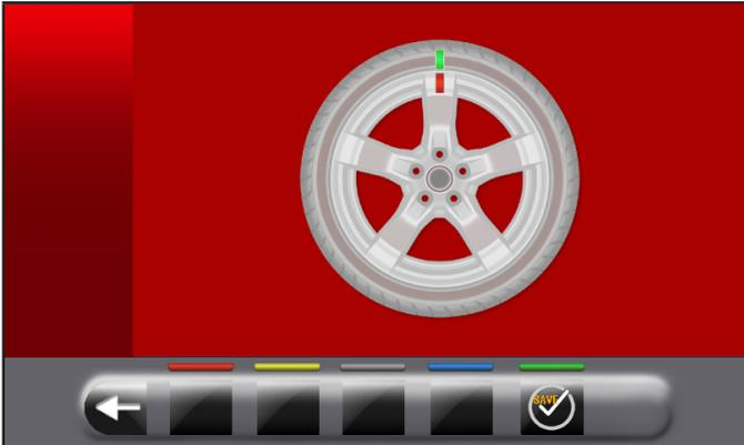
**PASO 1.** Llevar la flecha presente sobre la brida a “horas 12”. Marcar una línea de referencia, usando, por ejemplo una tiza, sobre la llanta y sobre el neumático en correspondencia de la flecha presente sobre la brida, para poder montar nuevamente la llanta en la misma posición en la máquina.
