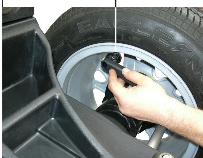
4. Llevar el brazo del calibre distancia-diámetro en posición de reposo, después de haberlo llevado hacia el mandril para desbloquearlo de la posición de aplicación peso.
