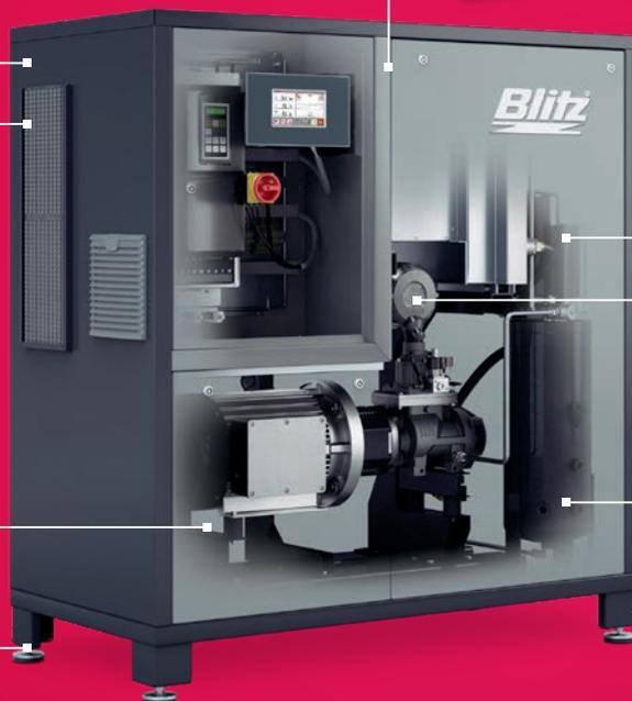
Separación de aceite multifase - Separación vertical por gravedad ya que un separador ciclónico asegura mínimas pérdidas de presión con el menor contenido residual de aceite.
