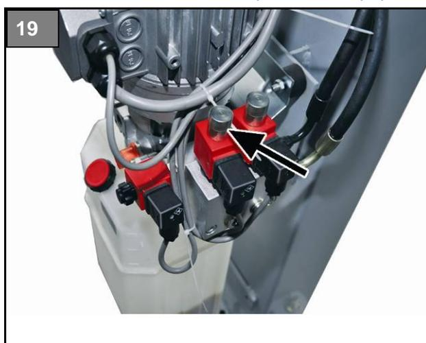
3. Retirez la soupape de la tige filetée et vissez le bouchon métallique entièrement (Manuel urgence=actif).
