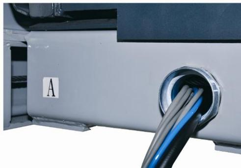
5. Insérez le raccord (protection en métal) pour les tuyaux flexibles de l'intérieur vers l'extérieur à l'intérieur de la rampe fixe et serrez celui-ci.
