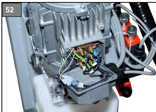
6. Faites passer des câbles d'alimentation électrique de l'interrupteur de contact thermique à 2 âmes (Fig. 52) par le presse-étoupe dans le boîtier de connexion et branchez-les (→diagramme du circuit en annexe).
