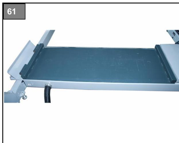
6. Insérez la plaque de remplissage de sorte que tous les boulons dépassent du côté inférieur de la rampe.
