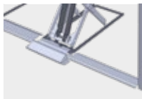
S518A20 1 m Schlauchabdeckung für Versionen "extra flach" auf dem Boden montiert
