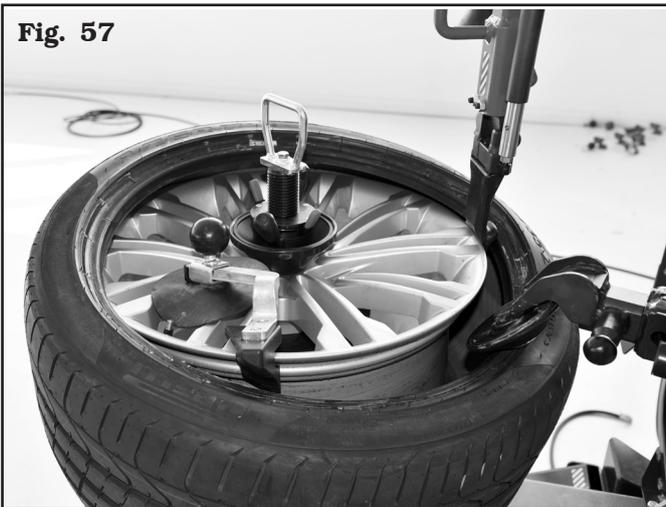
3. ruotare in senso orario fino al completo montaggio dello pneumatico (vedi **Fig. 58**);
