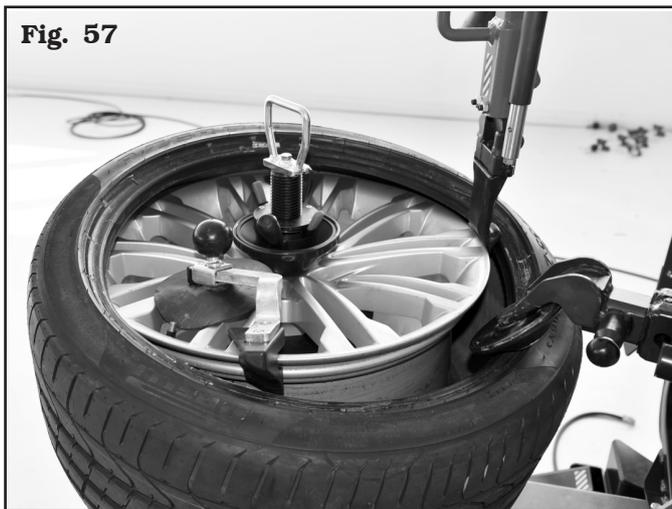
3. ruotare in senso orario fino al completo montaggio dello pneumatico (vedi **Fig. 58**);
