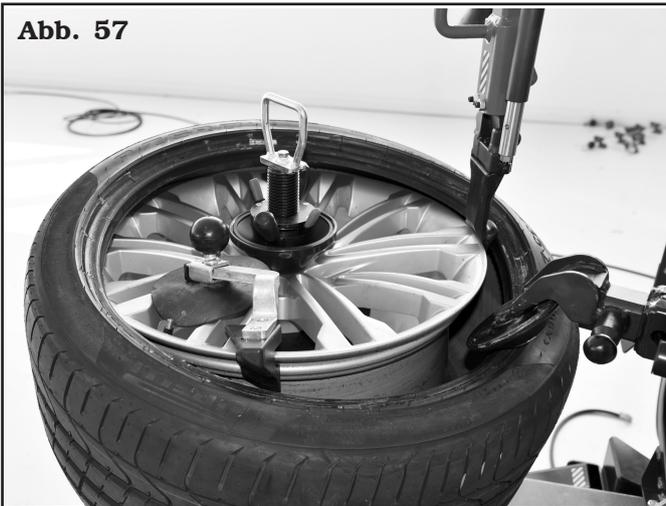
3. in Uhrzeigersinn drehen, bis den kompletten Einbau des Reifens (siehe **Abb. 58**):
