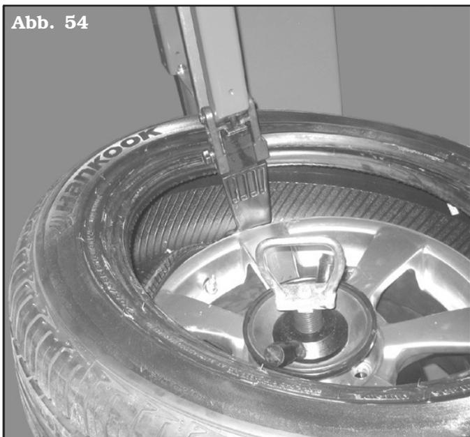
3. den unteren Wulst in den Werkzeugkopf einhängen und in Uhrzeigersinn drehen bis zur vollständigen Montage drehen;
