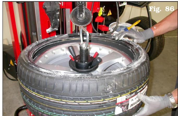
3. Coloque el talón superior en la cabeza útil. El equipo posiciona automáticamente la válvula en la posición correcta (10-15 cm (3,94"-5,91") delante del punto de tracción a las 4).
