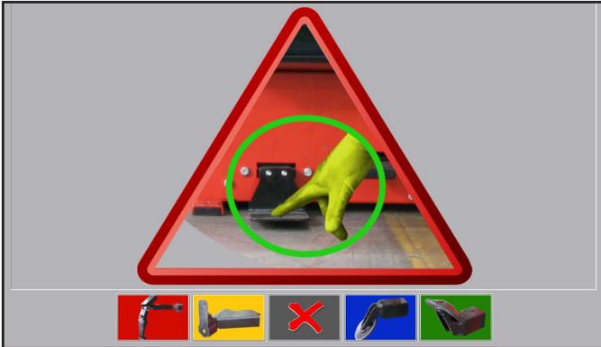
Al presionar rápidamente dos veces el pedal de consentimiento (**Fig. 23 ref. C**), el equipo está lista para el montaje automático (este tipo de operación ocurre si se selecciona la actividad de "desmontaje/montaje
