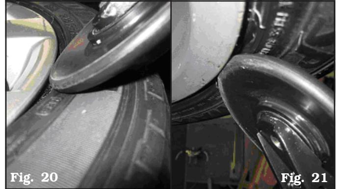
Si los rodillos destalonadores no están correctamente en contacto con el margen del borde llanta, usar la tecla (**Fig. 17 ref. D**) para moverlos diámetralmente hasta la posición correcta.
