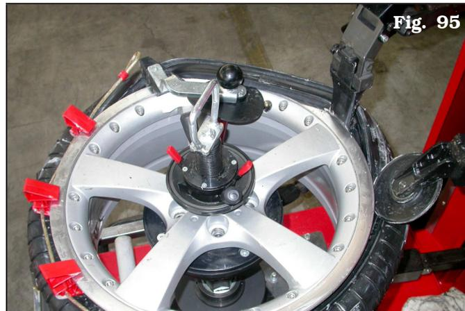
8. Si utiliza el dispositivo presionatalón, siga las mismas operaciones que para el empujatalón con guía.
