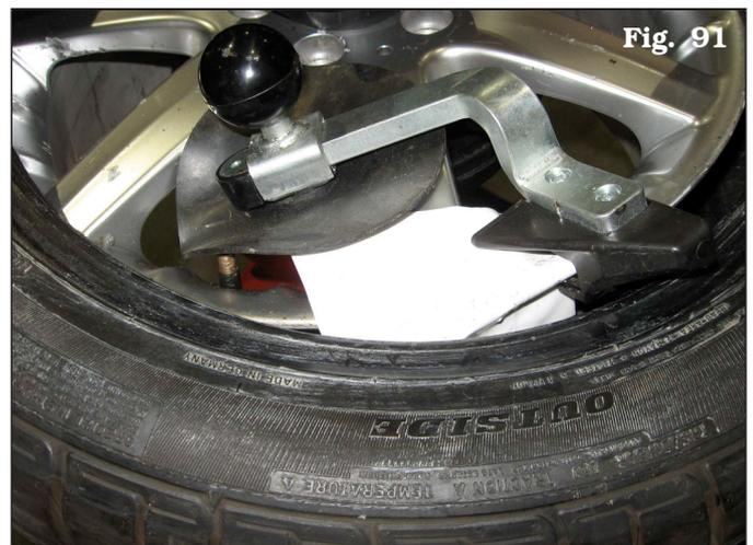
5. Girar más la rueda hasta que la válvula esté en la posición "6 en punto" y, utilizando el rodillo destalonador superior, introducir las cuñas del alargue presionatalón.
