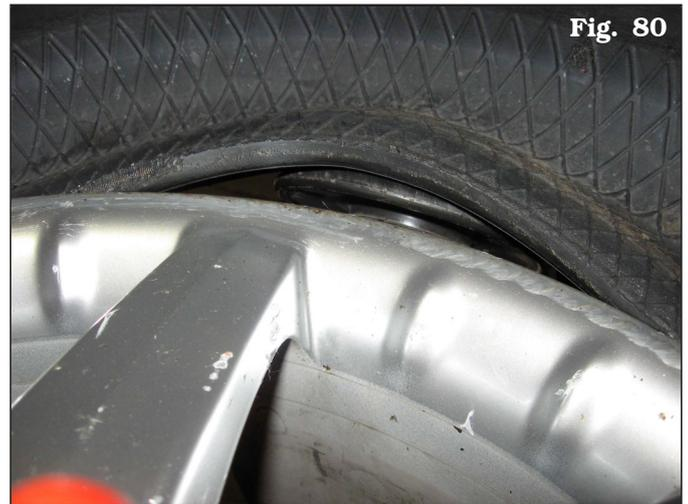
3. Mantenga presionado el pedal de consentimiento automático hasta retirar completamente el neumático.
