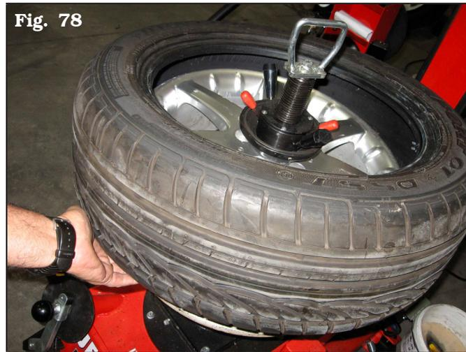
2. Levante el talón inferior del neumático con el rodillo destalonador hasta que el rodillo pase el borde de la llanta superior. La posición de la válvula se ajusta automáticamente.
