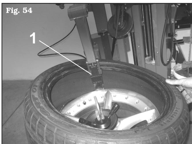
3. Enganchar el talón inferior en la cabeza útil y girar en sentido horario hasta completar el montaje.
