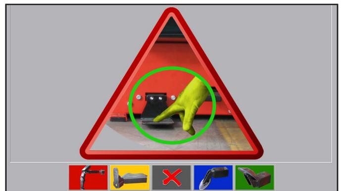
5. Pulsando y teniendo pulsado el pedal de consentimiento (**Fig. 23 ref. C**), el equipo realiza automáticamente todas las operaciones de desmontaje del neumático. Durante el desmontaje, el visualizador mostrará unas imágenes explicativas sobre las operaciones en progreso, es decir:
