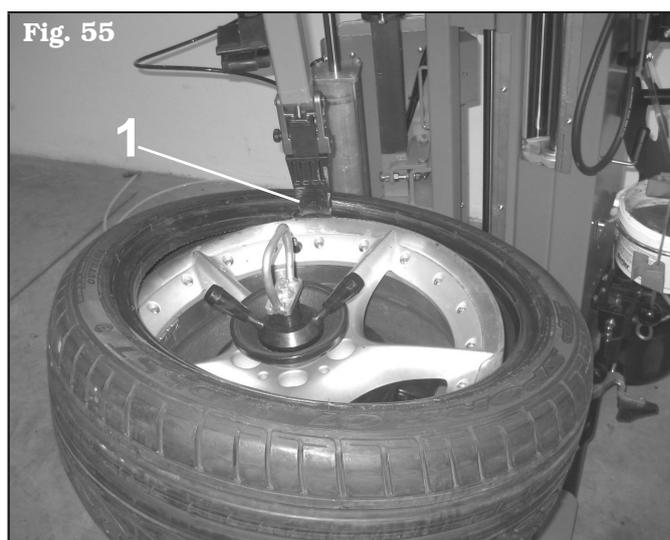
5. Montar el empujatalón con guía en el borde de la llanta (véase **Fig. 56**).
