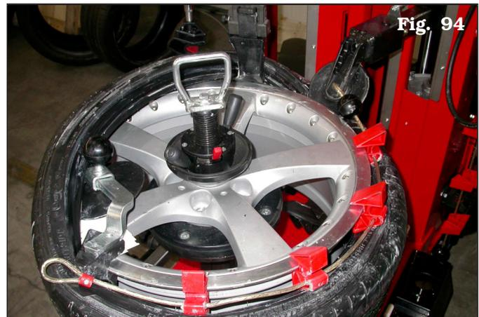
7. Coloque el talón a intervalos (soltando el pedal de consentimiento) para permitir que el neumático se adapte.
