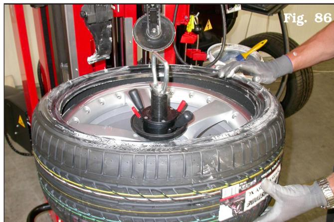
3. Placer le talon supérieur sur la tête outil. L'équipement positionne automatiquement la soupape dans la bonne position (10-15 cm (3,94"-5,91") devant le point de traction « 4 heures ».
