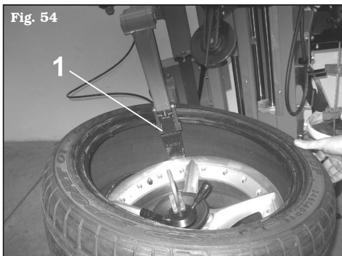
3. Accrocher le talon inférieur sur la tête outil et donc tourner dans le sens des aiguilles d'une montre jusqu'à la fin du montage.
