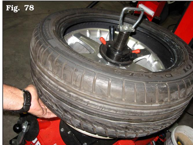
2. Soulever le talon inférieur du pneu avec le rouleau décolle-pneu jusqu'à ce que le rouleau dépasse le bord de la jante supérieure. La position de la soupape est automatiquement ajustée.
