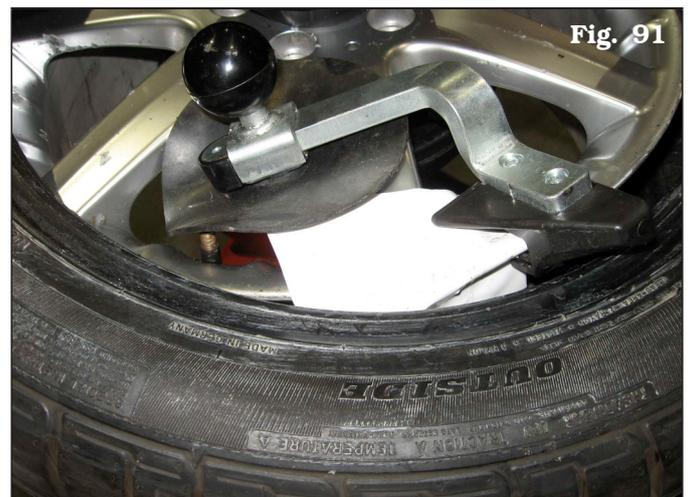
5. Tourner davantage la roue jusqu'à ce que la soupape soit à « 6 heures » et, à l'aide du rouleau décolle-pneu supérieur, insérer les cales de la rallonge pousse-talon.
