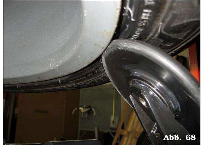
2. Stellen Sie das Reifenventil auf „1 Uhr“ (**Abb. 69**) und beginnen Sie mit dem Abdrücken des Reifenwulstes.
