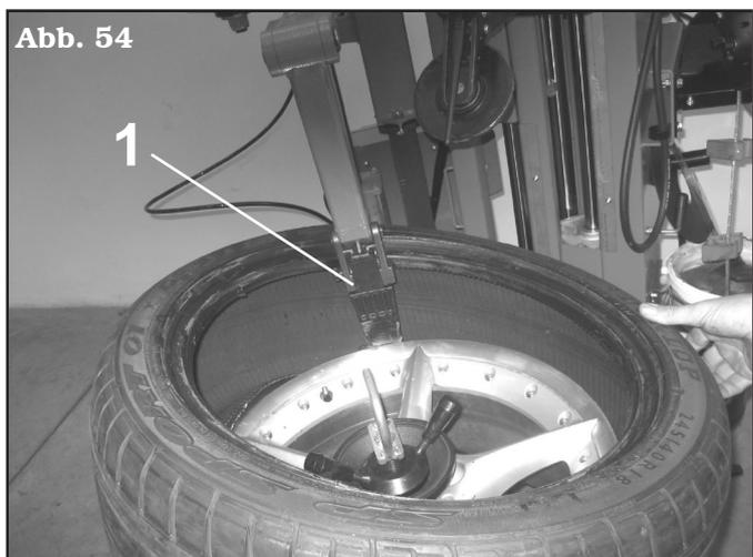
3. Den unteren Wulst in den Werkzeugkopf einhängen und in Uhrzeigersinn drehen bis zur vollständigen Montage drehen.
