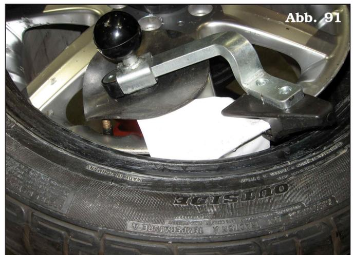
5. Drehen Sie das Rad weiter, bis das Ventil auf „6 Uhr“ steht und setzen Sie mit der oberen Abdrückerrolle die Keile der Abdrückerverlängerung ein.
