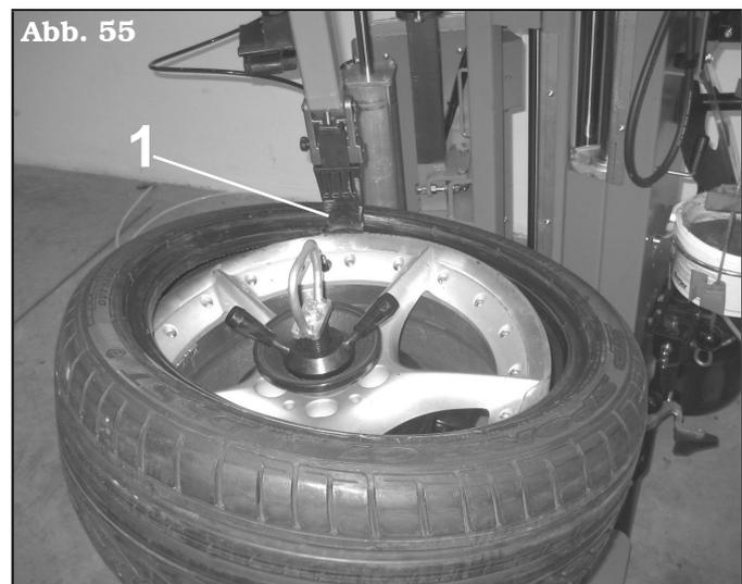
5. Montieren Sie den Wulstniederhalter mit Führung am Felgenrand (siehe **Abb. 56**).
