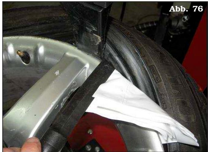
5. Drücken Sie das automatische Freigabepedal, bis die obere Ferse vollständig demontiert ist.
