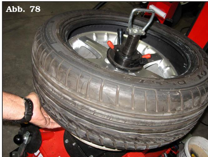
2. Heben Sie den unteren Reifenwulst mit der Abdrückerrolle an, bis die Rolle den Rand der oberen Felge freigibt. Die Ventilposition wird automatisch angepasst.
