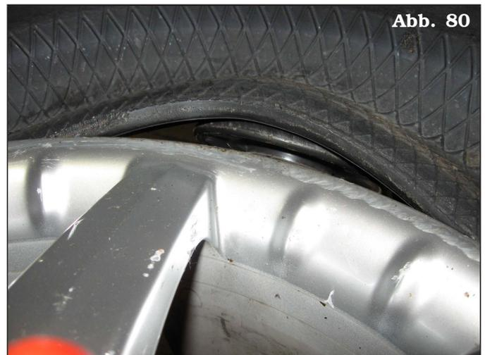
3. Halten Sie das automatische Freigabepedal gedrückt, bis der Reifen vollständig entfernt ist.
