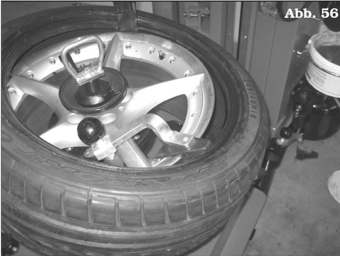
6. Die obere Abdrückrolle herunterlassen, so dass der Reifenwulst auf der Höhe der Felgenfurche gehalten wird (siehe **Abb. 57**).
