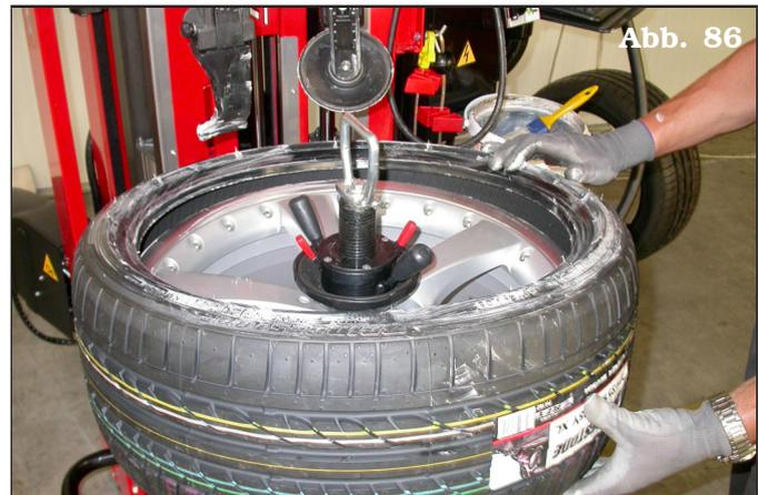
3. Setzen Sie den obere Wulst auf den Werkzeugkopf. Das Gerät positioniert das Ventil automatisch in der richtigen Position (10-15 cm (3,94"-5,91") vor dem Zugpunkt „4 Uhr“.
