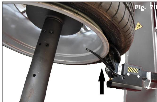
5. Termine de levantar la cabeza útil, coloque el dispositivo presionatalón aproximadamente a las 6 en punto en el neumático (**Fig. 71**).
