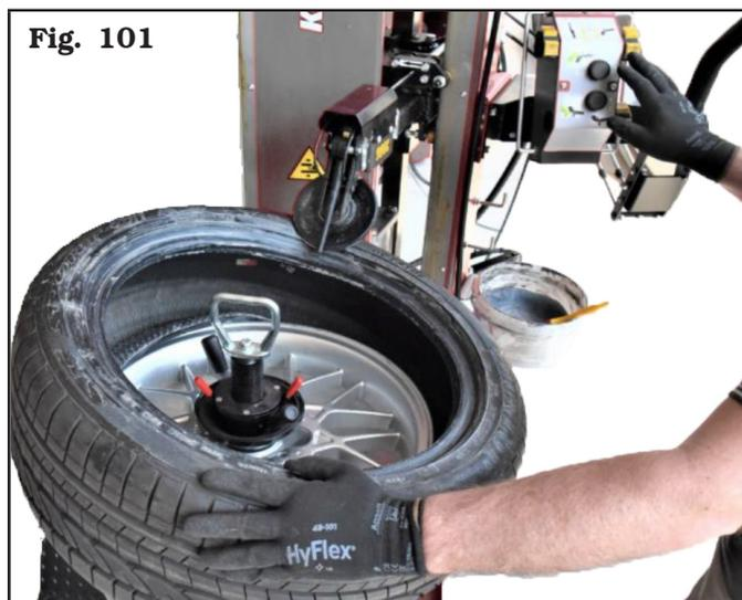
4. Pulsando el pedal de rotación, posicionar la válvula aproximadamente a las 3, actuando sobre el pulsador correspondiente (**Fig. 59 ref. C**), posicionar la cabeza útil en el borde de la llanta.
