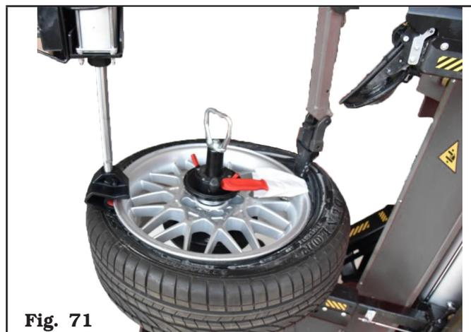
6. Inserte el útil de protección del talón junto con las láminas entre el talón del neumático y la llanta y bloquee el útil de protección con la mano. Presione el pedal de rotación y retire el primer talón del neumático (Fig. 72).
