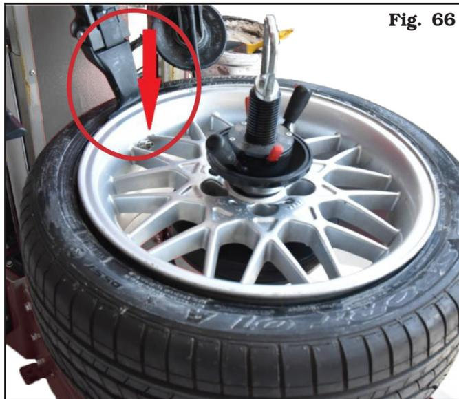
2. Inicie la rotación de la rueda (sin parar hasta que se inserte la cabeza útil. Cuando la válvula esté aproximadamente a las 3 en punto (**Fig. 67**), presione el botón de descenso de la cabeza útil (**Fig. 59 ref. C**) e introdúzcalo en el neumático (**Fig. 68**).
