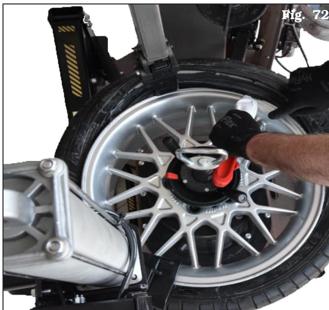
7. Pulsar el botón correspondiente (Fig. 59 ref. C). Levante la cabeza útil y aléjela del neumático.
