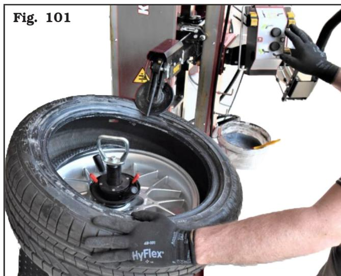
4. Premendo il pedale di rotazione, posizionare la valvola circa a "ore 3", agendo sull'apposito pulsante (**Fig. 59 rif. C**), posizionare la testa utensile sul bordo del cerchio.
