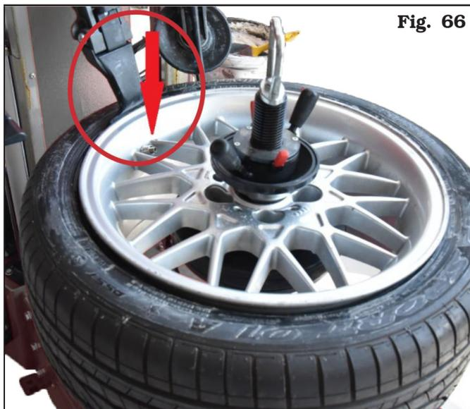
2. Iniziare la rotazione della ruota (senza fermarsi fino a inserimento della testa utensile). Quando la valvola sarà circa a "ore 3" (**Fig. 67**) premere il pulsante di discesa della testa utensile (**Fig. 59 rif. C**) e inserirla nello pneumatico (**Fig. 68**).
