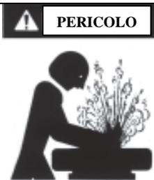
Lo scoppio di un pneumatico può causare gravi lesioni o addirittura la morte dell'operatore.
