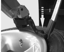
3. tirer le talon du pneu sur la tête outil avec le levier lève-pneu ;
