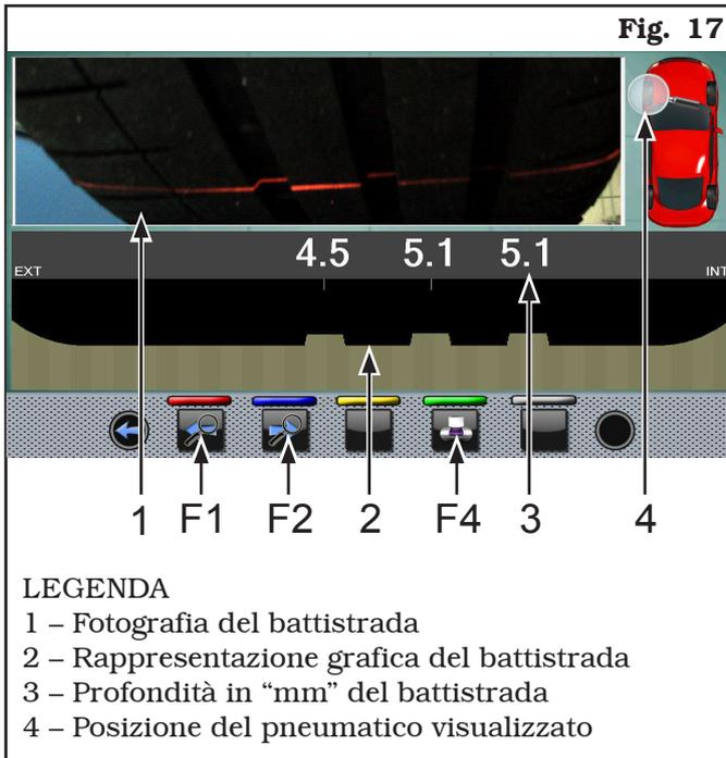
Premendo i tasti “F1” o “F2” (vedi **Fig. 17**) è possibile cambiare la selezione della ruota da visualizzare (vedi esempi riportati di seguito).
