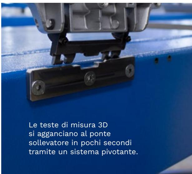
Le teste di misura 3D si agganciano al ponte sollevatore in pochi secondi tramite un sistema pivotante.
