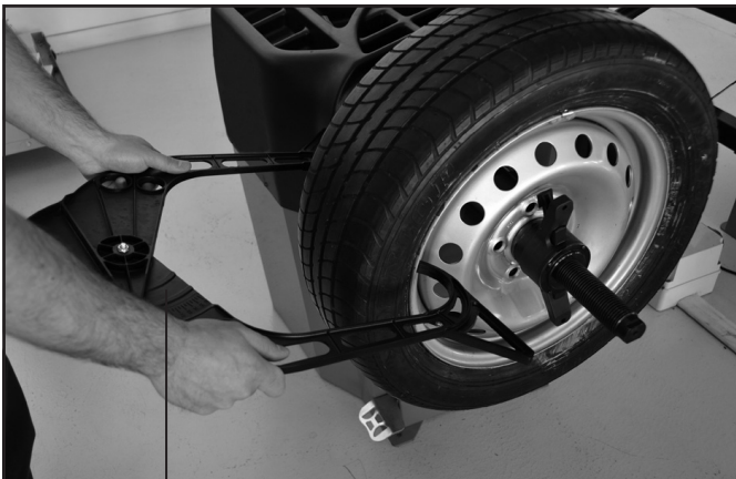
PALPADOR MANUAL. Medición manual anchura
