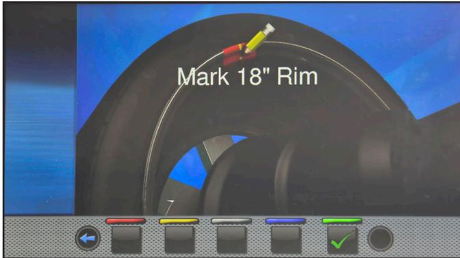
Remplacer la roue petite (13"/14") avec celle de diamètre majeure (18"/19") et répéter les opérations décrites précédemment. Au terme du réglage apparaîtra la page-écran suivante :
