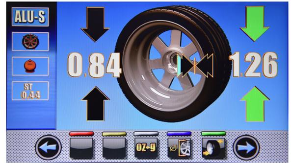
En appuyant sur la touche
