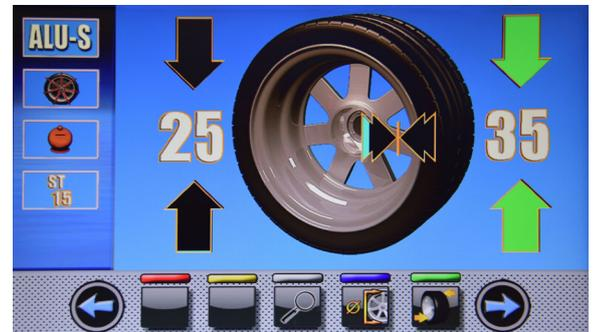
En appuyant sur la touche
