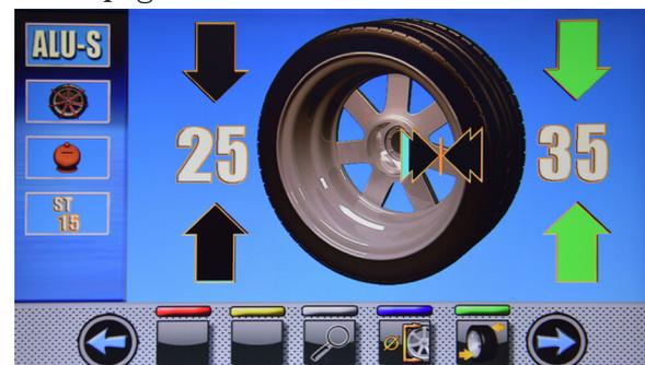
En appuyant sur la touche on affichera le poids avec résolution maximum (1 g) à appliquer à la roue, exprimé en grammes.
