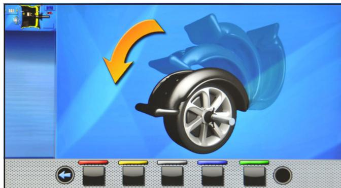
Après avoir remonté la roue, fermer le carter de protection pour effectuer le lancement automatique. À la fin du lancement sur l'écran apparaîtra la page-écran suivante:
