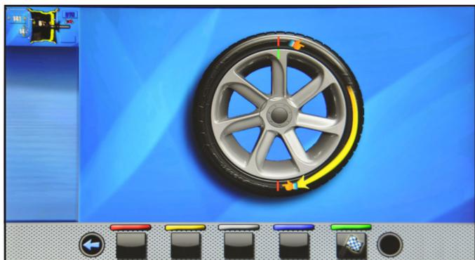
**ÉTAPE 2.** Enlever la roue de l'équilibreuse. Démontez le pneu et le tourner de 180 degrés sur la jante.
