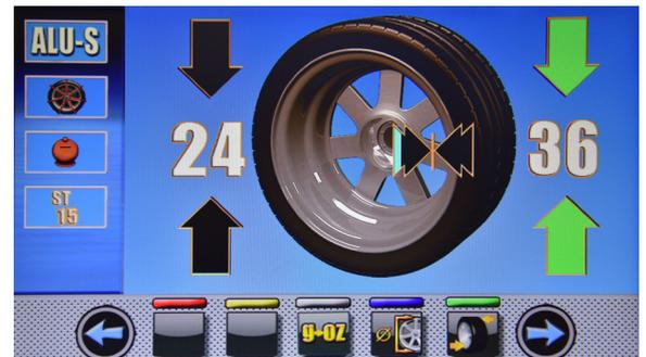
En appuyant sur la touche
