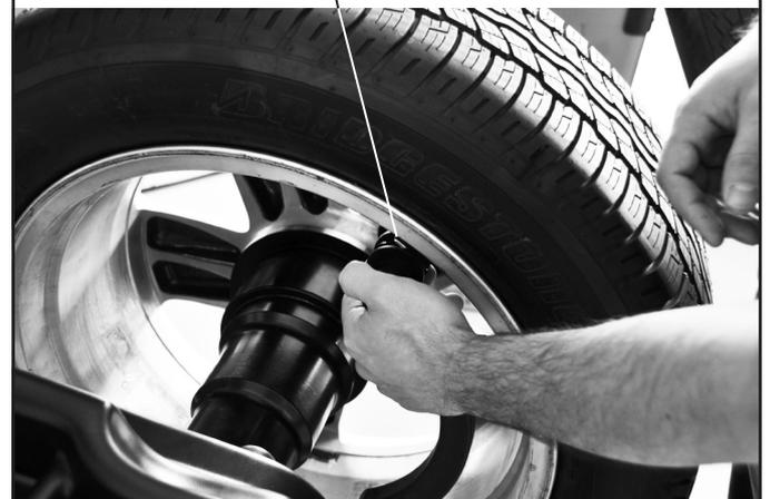
À la fin de la procédure, il est possible de vérifier les conditions d'équilibrage de la roue en effectuant un ultérieur lancement de contrôle.
