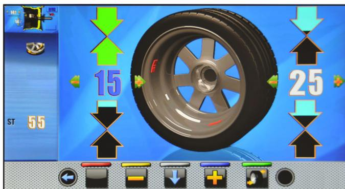
Répéter les opérations décrites précédemment pour les poids à appliquer à l'intérieur de la roue. À la fin effectuer à nouveau un lancement de contrôle pour vérifier la correcte distribution des poids.
