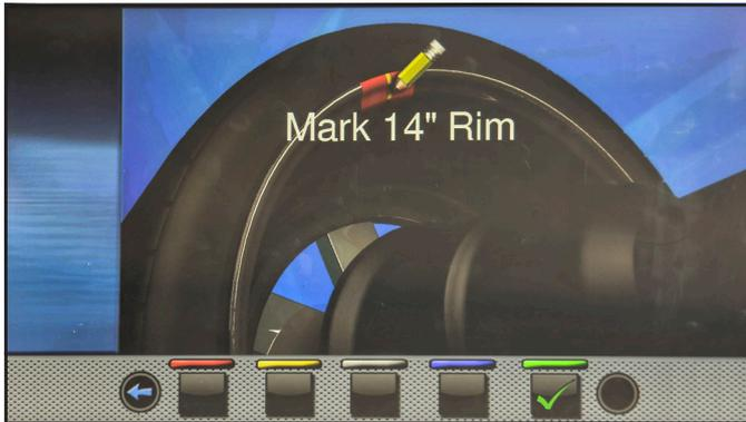
Monter la roue petite (diamètre 13"/14") sur le mandrin et appliquer un poids adhésif dans un n'importe quel point à l'intérieur de la jante. À la fin de l'opération
