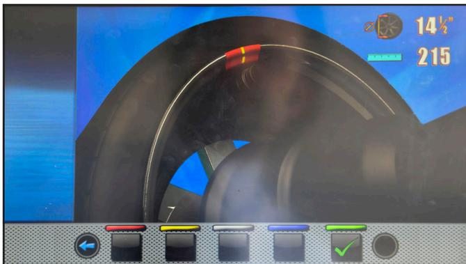
Porter la pince d'application du poids de la tige à contact avec le poids adhésif appliqué précédemment, en tournant manuellement aussi la roue et en faisant attention à la porter à contact avec la partie centrale du poids (voir Fig. 82).
