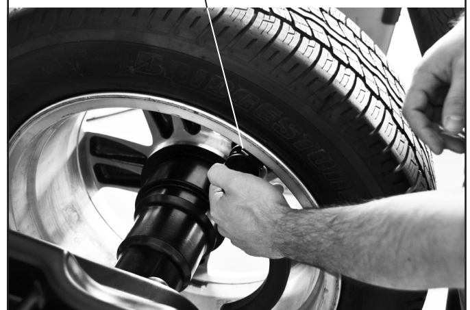
Abb. 65 Das Gewicht in der Position anbringen, in der die Klemmzange das Rad berührt
