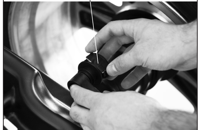
Abb. 64 Das Klebegewicht in die Zange des Tasterstabs einsetzen
