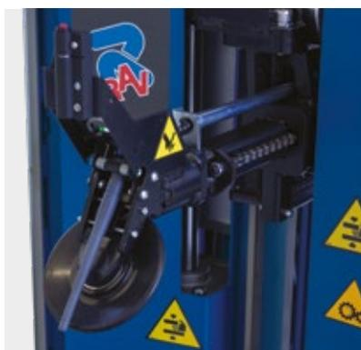
Sensor con activación automática de la función de avance de los discos para un destalonado preciso y seguro de los neumáticos.
