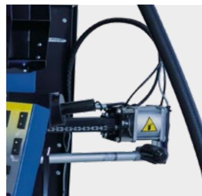
Actuador electromecánico que, mediante un sistema de sincronización por cadena de carga, controla el movimiento simultáneo de los tres brazos de trabajo.
