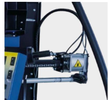
Elektromechanischer Antrieb, der die gleichzeitige Bewegung aller drei Bedienarme über ein Kettensynchronisierungssystem steuert.
