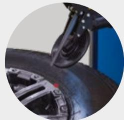
Laserpointer für die Anzeige der korrekten Vorrichtungspostionierung.
