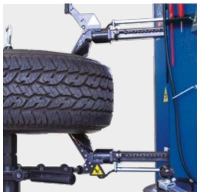
Doppelabdrückrollensystem für die Wulst. Der Reifen wird mit Hilfe von zwei synchronisierten, gegenüberliegenden Rollen schnell und sicher abgedrückt.
