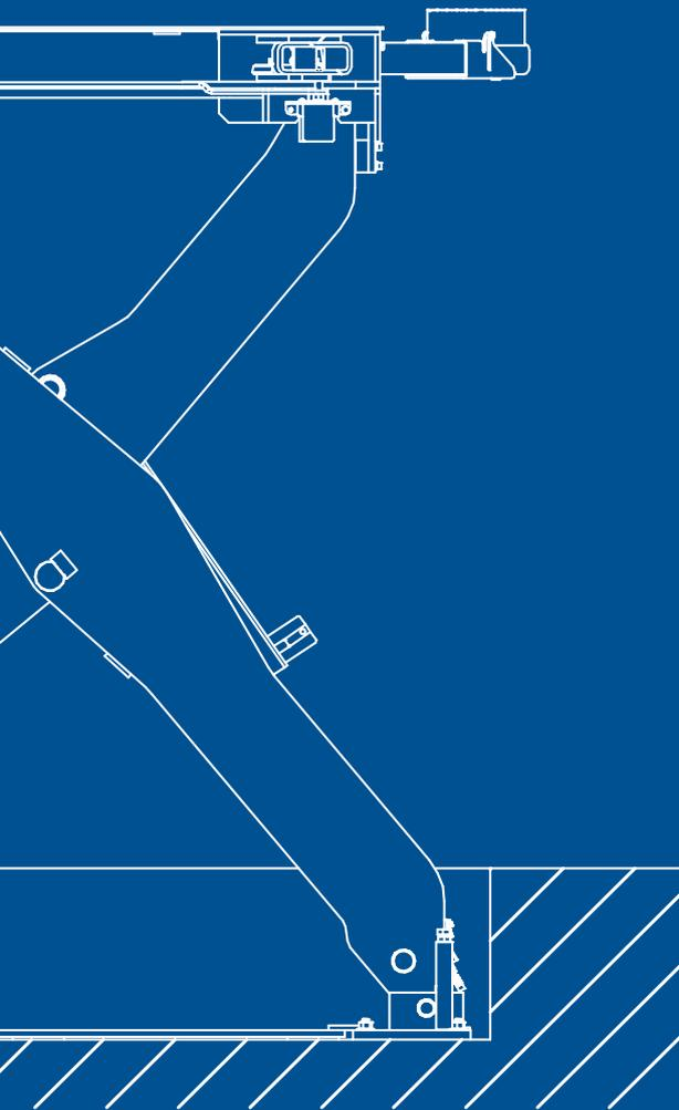
Die Scherenhebebühne ist ideal für den Einbau in Gitterroste von Lackierkabinen und Vorbereitungsbereichen sowie für den Einbau in herkömmliche Böden geeignet. Durch das **ergonomische Design** sind die Haltepunkte der Fahrzeuge leicht zu erreichen, **wodurch alle Hindernisse rund um das Fahrzeug beseitigt** und die Arbeiten an der Karosserie erleichtert werden.
