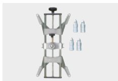
STDA33EU Pareja de garras con autocentrado de 4 puntos, para llantas de 10" a 24"
