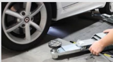
Possibilità di utilizzare il braccio in modalità standard o inclinato fino a 90°.
