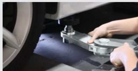
Il terminale è facilmente regolabile a seconda della tipologia di vettura su cui si sta lavorando.
